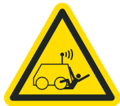
20358 ADVARSEL Automatiserte kjøretøy
